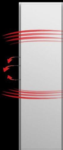
ICON incorpora due sistemi di riscaldamento integrati, la tecnologia DUAL-THERM. La convezione, emessa attraverso i profili laterali, permette di raggiungere velocemente il comfort desiderato nella stanza ed al contempo di reagire tempestivamente alle variazioni di temperatura.
