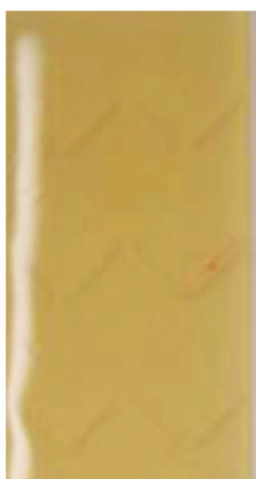
Slide batterica con 100% biocida (Sotto 1,000 UFC) Biocidi chimici tengono i livelli di UFC al minimo.
