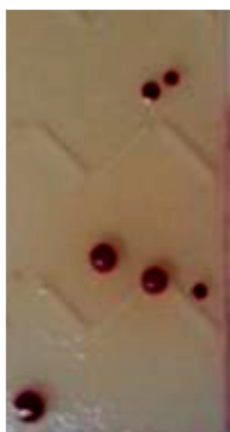
Dopo 1.5 mesi con biocida ridotto del 50% (tra 1,000 e 5,000 UFC) Leggero aumento della conta UFC poiché HydroFLOW ha iniziato a rimuovere il biofilm dalla torre evaporativa.
